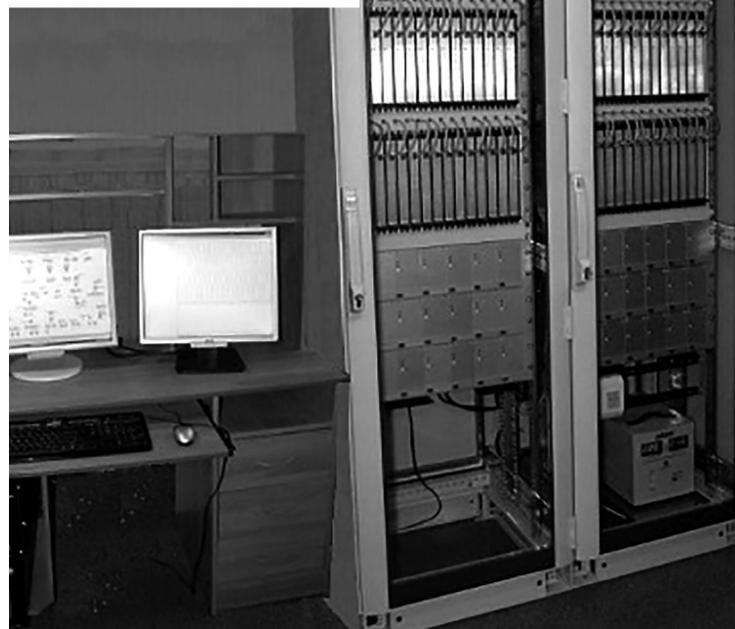
С помощью моделирующего комплекса политехников можно будет проводить эксперименты на виртуальной копии настоящей электростанции.
