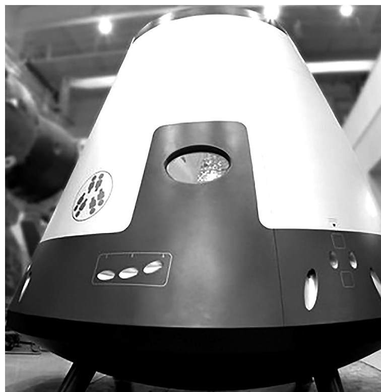
На пилотируемые транскортные корабли РКК «Энергия» будут устанавливать иллюминаторы со стеклами, обработанными по технологии томских ученых.
