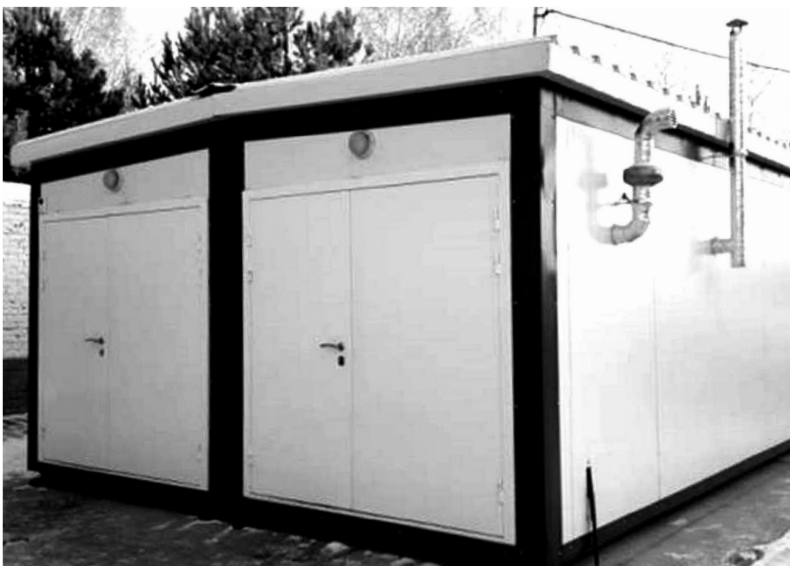
Мобильный блок-бкс с системой очистки воды на базе импульсного электронного ускорителя. Габариты установки: 10×5×2,5 м.
